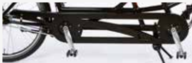
Freewheel crankstel: Het optionele freewheel crankstel geeft de mogelijkheid om onafhankelijk van elkaar te trappen.
